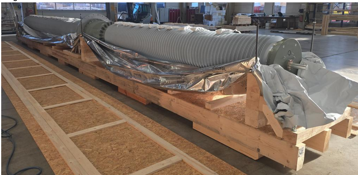
Abbildung 4: Lagerung der Durchführung in der Kiste
